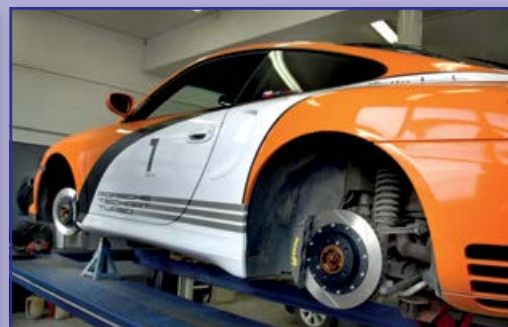
PORSCHE 911 996 - brzdový kit pro celé vozidlo, komponenty AP RACING, WILWOOD, RENSSPORT
