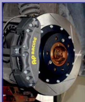
PORSCHE 911 996 - brzdový kit pro celé vozidlo, komponenty AP RACING, WILWOOD, RENSSPORT
